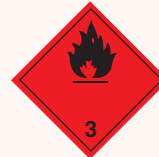
3 Brandbare vloeistoffen 3 Liquides inflammables
