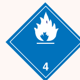
4.3 Stoffen die in contact met water brandbare gassen ontwikkelen. 4.3 Matières qui développent des gaz inflammables au contact de l'eau.
