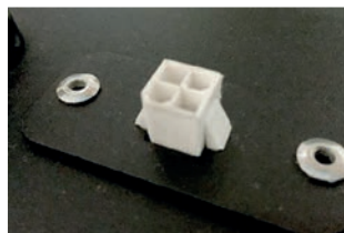
Diagnose-stekker aansluiting Artikel Nr OPT0270
